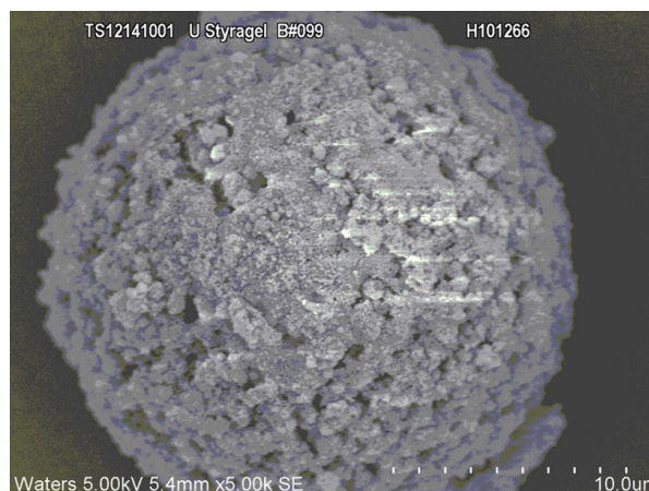
Obr. 7. Skenovací elektronová mikrofotografie 20 \mu\text{m} porézní částice 10 6 Styragelu. (Snímek byl získán díky Martinovi Gilarovi, Waters Corporation)
