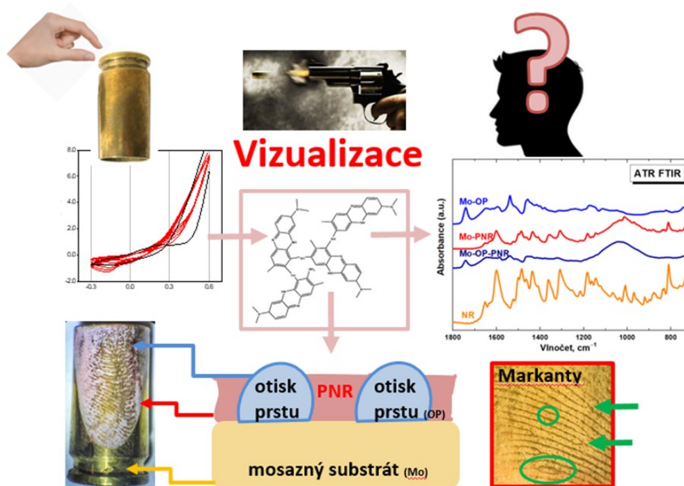
Obr. 1. Strategie elektrochemické vizualizace LOP pomocí polymerního filmu (PNR) na vystřelených nábojnicích 12
