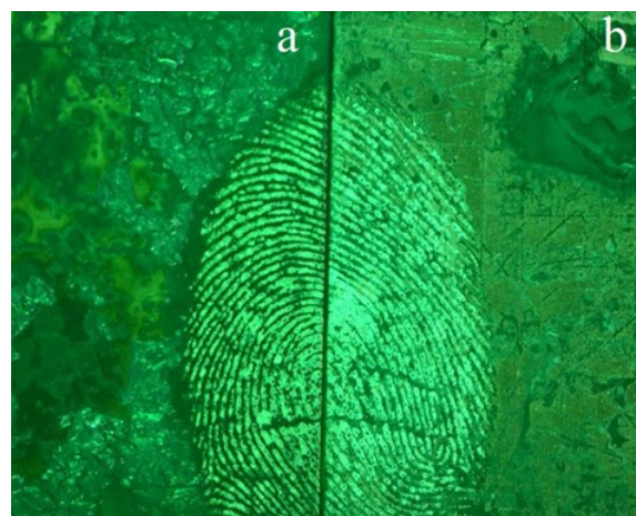
Obr. 4. Zviditelněný otisk prstu na mosazném povrchu pomocí: a) Lumicyanu; b) klasického kyanoakrylátu (upraveno podle cit. 6 )
