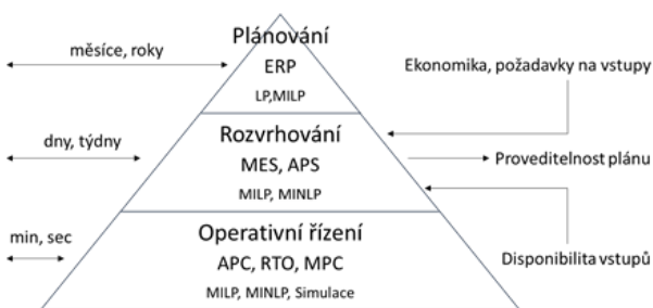
Obr. 2. Plánování, rozvrhování a operativní řízení v COSC z pohledu informačního systému podniku; upraveno dle cit. 3
