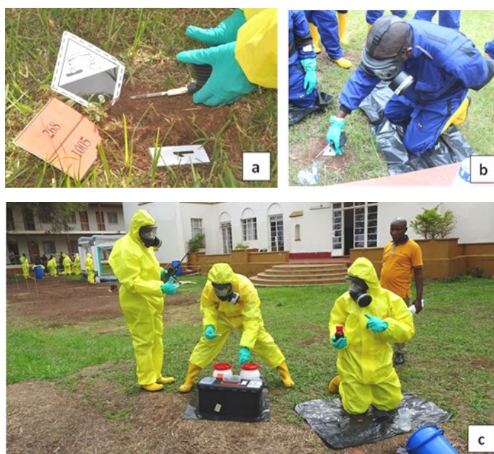
Obr. 3. Detekce a odběr vzorků. a) Detekce amoniaku detekční trubičkou DT-008. b) Odběr par neznámé látky na sorpční trubičku. c) Návčik odběru vzorků pod vedením instruktora z Burundi
